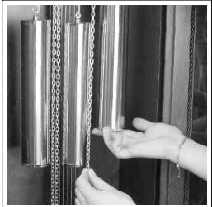
Bild 11 / Picture 11 / Figure 11 / Ilustración 11 Die Uhr aufziehen (Kettzugwerke) Winding the clock (chain movements) Remonter l'horloge (mouvements à chaînes) Dar cuerda al reloj (movimientos a cadenas)
