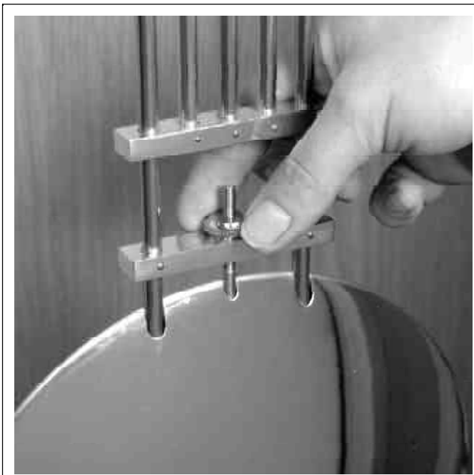
Bild 13 / Picture 13 / Figure 13 / Ilustración 13 Das Pendel einregulieren (Kompensationspendel) Adjusting the pendulum (compensation pendulums) Réglage du pendule (pendule à compensation) Regular la péndola (péndola de compensación)
