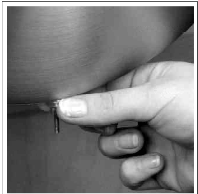
Bild 12 / Picture 12 / Figure 12 / Ilustración 12 Das Pendel einregulieren (Standardpendel) Adjusting the pendulum (standard pendulums) Réglage du pendule (pendule standard) Ajustar la péndola (péndola estandard)
